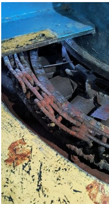
Рисунок 3-3 Приклади кородованих обмоток у зношеному електродвигуні
